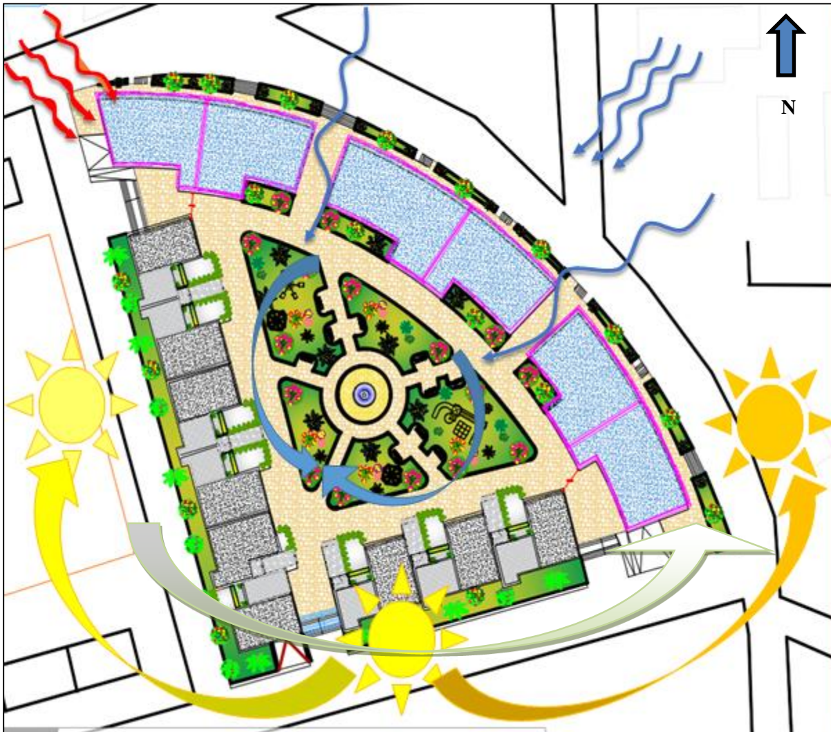
Figure 127 : L'implantation et orientation du bâtis .
