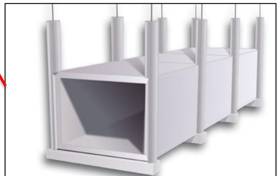
Figure 154 : la gaine de ventilation
