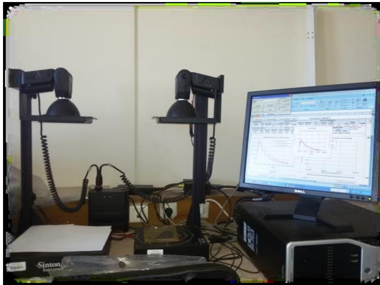
Fig.I.16 : Photo du banc QSSPC pour la mesure de la durée de vie des prêcheurs de charges dans le silicium
