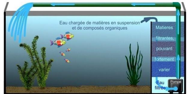
schéma de principe du système de filtration d'un aquarium
