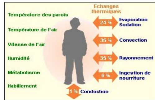
Fig 02. Echanges thermiques http://www.labo-energetic.eu
