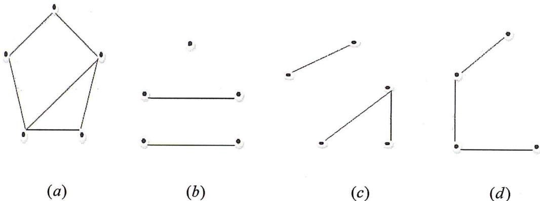
Figure 1.3: (a) Un graphe  $G$ , (b) sous graphe de  $G$ , (c) graphe partiel de  $G$  et (d) sous graphe induit de  $G$ .
