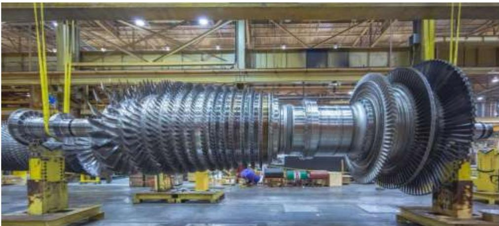
**Figure 1.7** : Compresseur à 18 étages du Turbine à gaz 9FB
