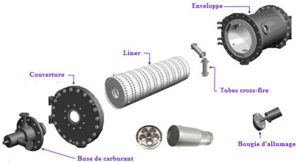
**Figure 2.3:** Composant principal de la chambre de combustion
