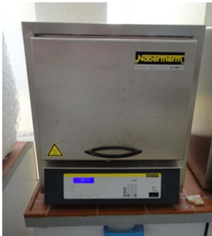
**Figure 4.5** four de préchauffage « Nabertherm »
