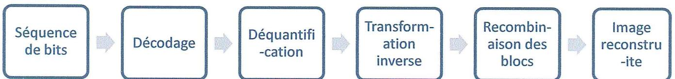
Fig 3.6 Schéma de principe de la compression/décompression par transformation
