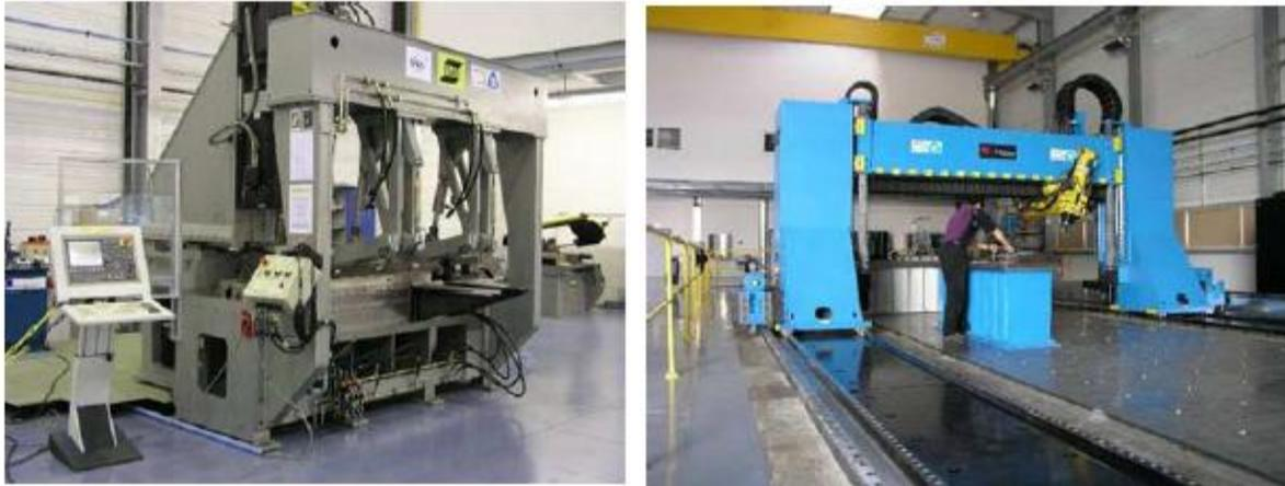
**Figure III.1:** Machines de soudage FSW de l'Institut de Soudure (Metz) (a)- Machine ESAB. (b)- Machine MTS.
