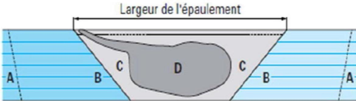
**Figure III.9 :** Coupe transversale schématique d'une soudure.
