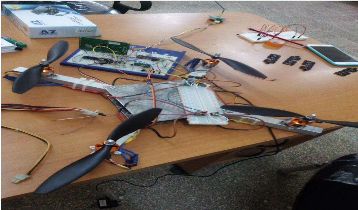
Figure 3-45 : Essai 4 moteur + hélices + moteur pas à pas
