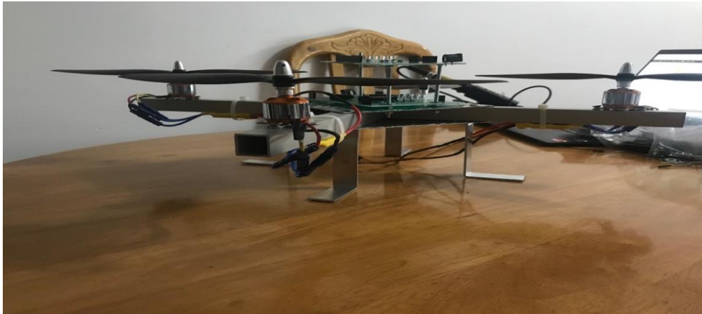
Figure 4-19 : Fixation des 2 PCB implementes sur notre drone
