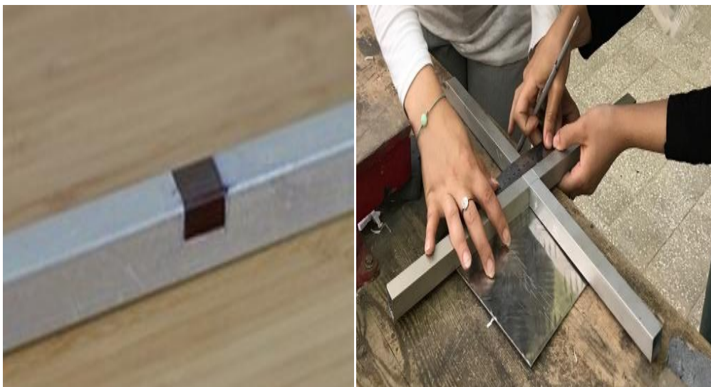
Figure 4-5: Découpage et assemblage à mis tube
