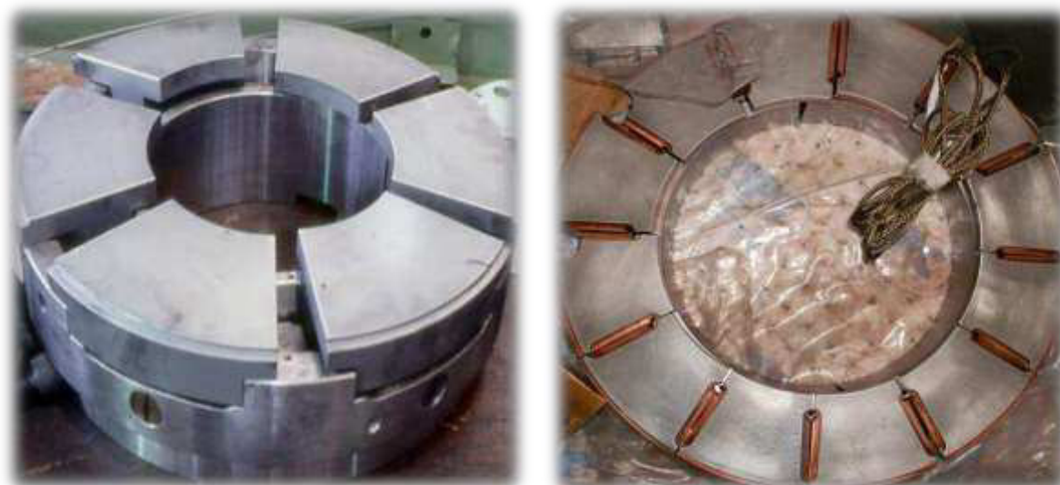
Figure 1.18 :Paliers radiaux (a : palier radial lisse ;b :palier radial a patins)
