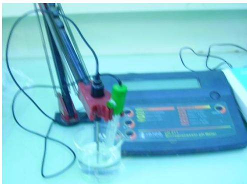
**Figure (e):** pH mètre de type Hanna Instrument
