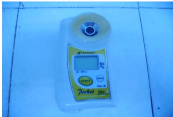
**Figure (d):** réfractomètre électronique
