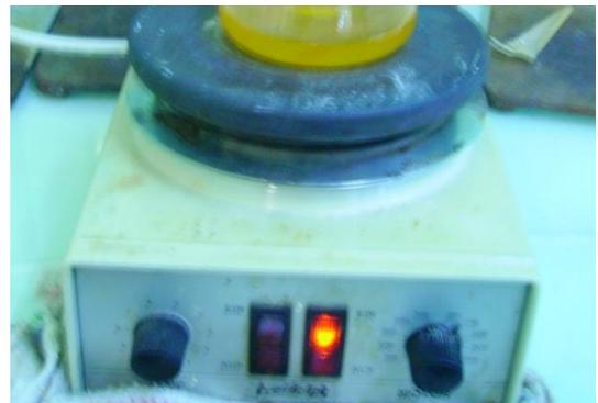
**Figure (f):** agitateur magnétique
