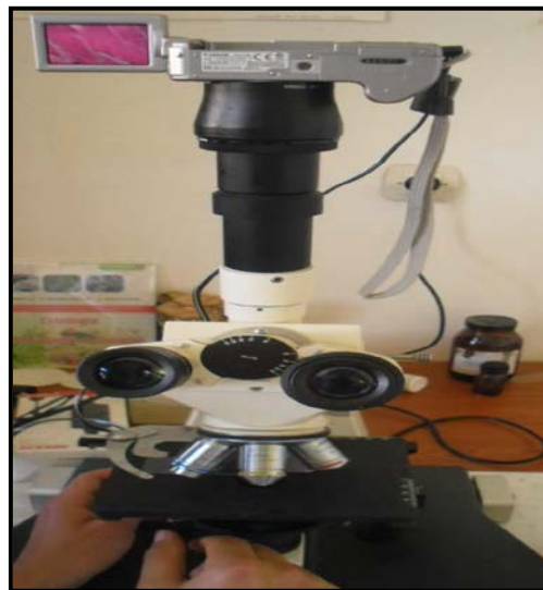
Figure 45: Microscope photonique : « Leica DME », avec un appareil photo numérique de marque : Canon PowerShot A80 (Photo originale, 2013).
