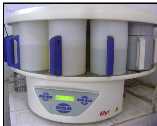
Figure 23 : Déshydratation à l'aide d'un Automate de type : Myr Stp 120. (Photo originale, 2013).
