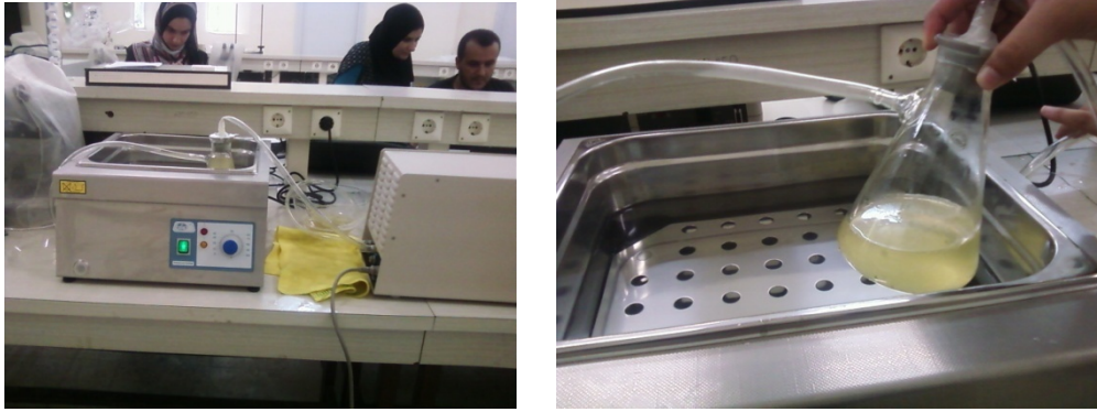
Figure N°2.4 : Filtration sous vide
