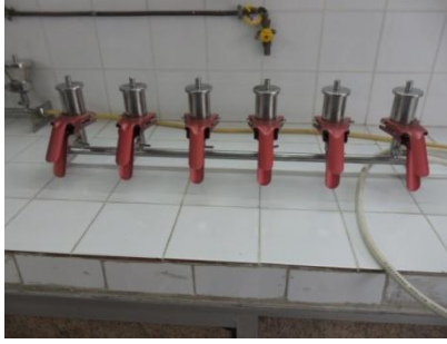
Rampe de filtration
