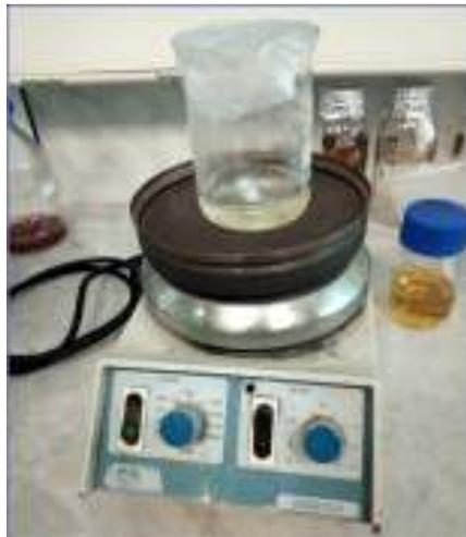
**Figure 15 :**homogénéisation de la solution en HE à l'aide d'un agitateur magnétique(Photographie originale)
