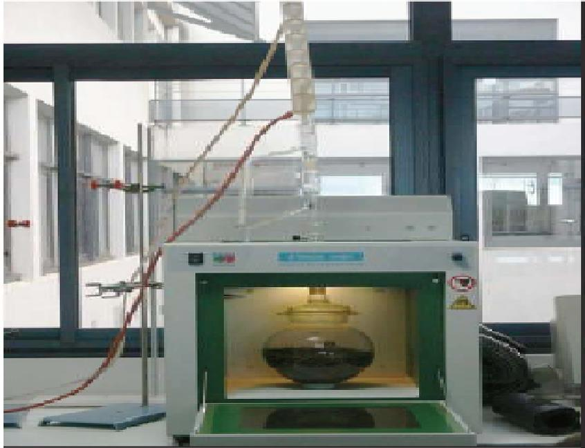
**Figure 5 :** photographie d'extraction par micro- ondes(Bouaine A., 2017)
