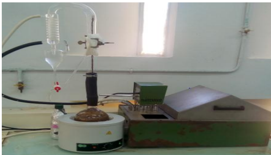
Figure 3.7 : Appariellage utilisé :type Clevenger.(Origirale,2019)
