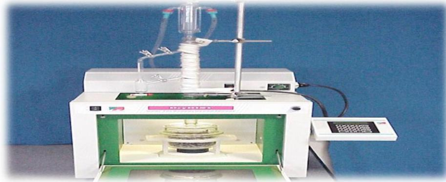
**Figure 5 :** Photo montrant un système d'extraction assistée par micro-ondes (Smadja, 2009).
