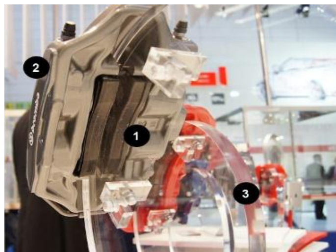
Figure I.5 : Fonctionnement d'un frein à disque [10]
