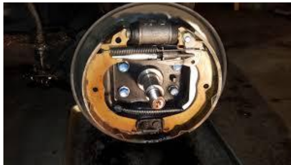
Figure I.2: Illustration d'un frein à tambour
