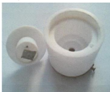
Figure 3-1: Cellule d'anodisation du silicium poreux
