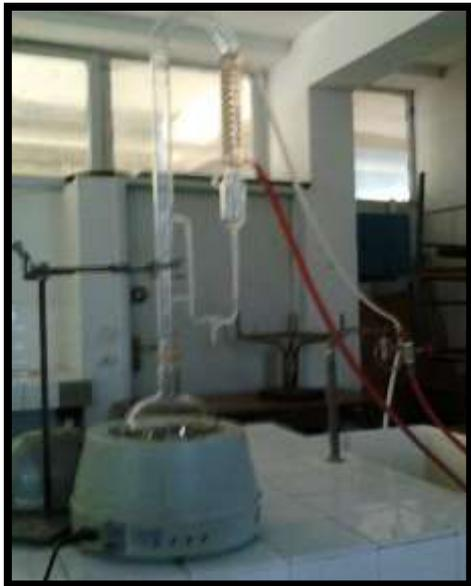
**Figure30** : photo original d'un hydrodistillateur (a clevenger)
