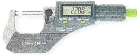
Figure II.12 : un palmer digital utilisé au niveau de CRNA.
