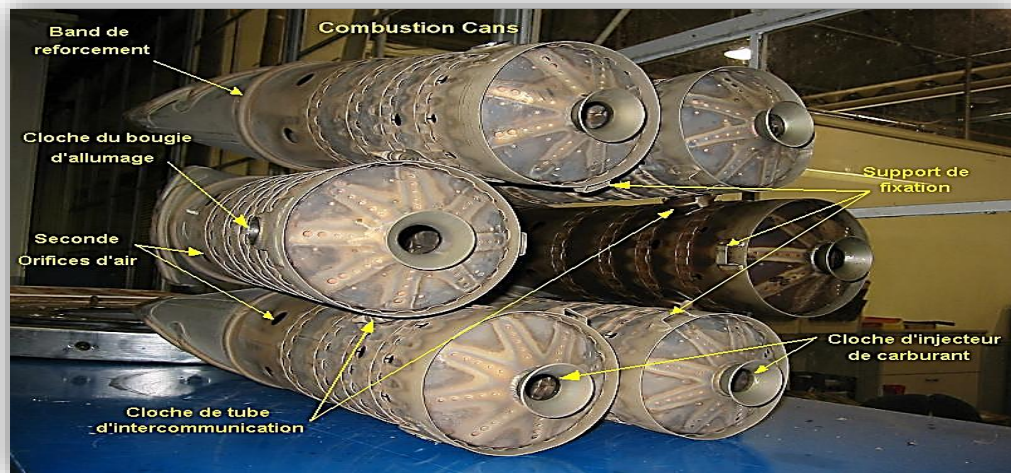
Fig(1.6) chambre de combustion [67]
