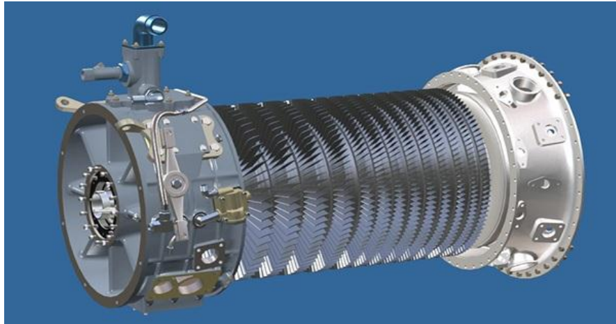
Fig 1.5 compresseurs moteur Allison T56 [68]
