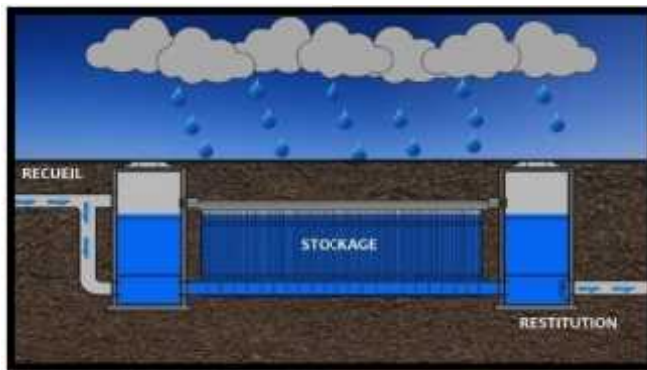
Figure 144: Technique de stockage de l'eau pluviale
