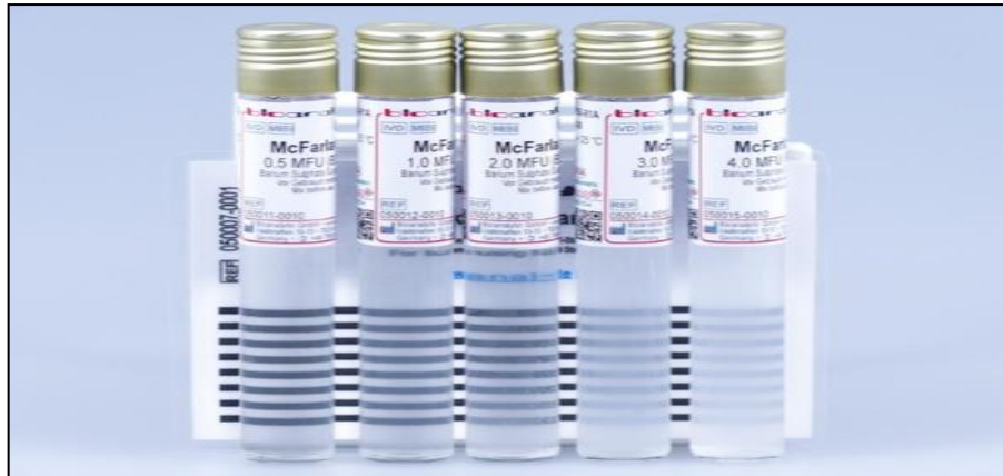
Figure 4.3 : Standards McFarland de turbidité utilisés pour la préparation des suspensions de microorganismes [146].
