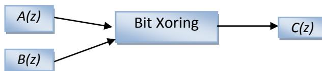
Figure 4.4 : Addition modulaire dans  $GF(2^m)$ .
