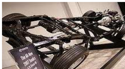
Figure I.3 : Châssis de camionnette Pickup, avec le moteur, le train roulant, la suspension et les roues.
