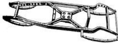
Figure I.3 : Châssis en échelle avec entretoises diagonales et trous d'allègement.
