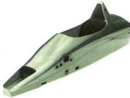
Figure I.5 : Exemple d'un châssis monocoque en aluminium.
