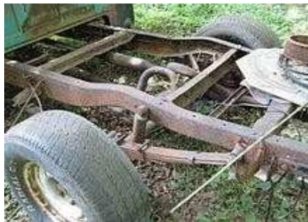
Figure I.1 : Châssis de Pick-up. Notons la traverse en forme de chapeau dans le fond, des profilés en forme de C, des traverses latérales au centre et un léger arc au-dessus de l'axe.
