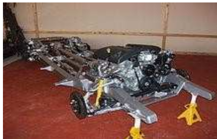
Figure I.2 : Châssis personnalisé hautes performances, utilisant des rails boîte et des sections de tube.
