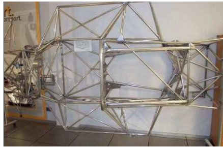
Figure I.7: exemple de châssis tubulaire en acier.
