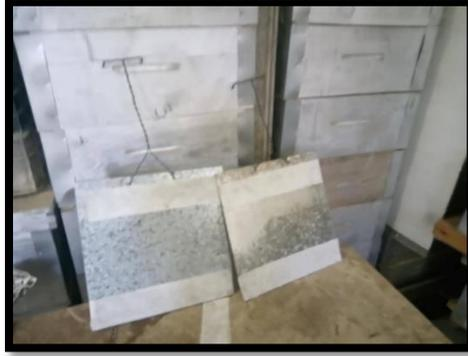
Figure n°11: Plaques métalliques graissées avec des bandes de papier buvard (Originale, 2018).
