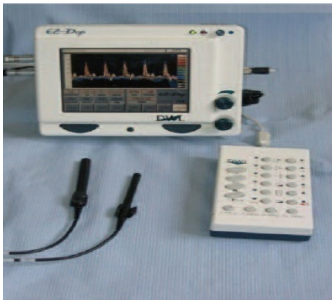
Annexe 1 : Appareil Doppler à onde continue avec deux sondes et analyse spectrale.
