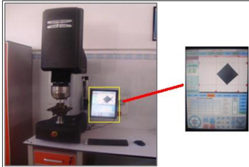
Figure 3 - 20 Appareil de mesure de la dureté
