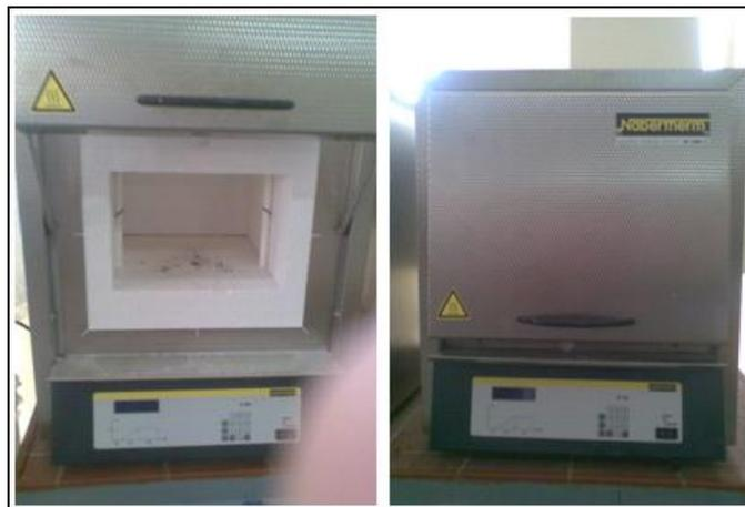
Figure 3 - 12 Four à moufle Nabertherm de type LT5/12
