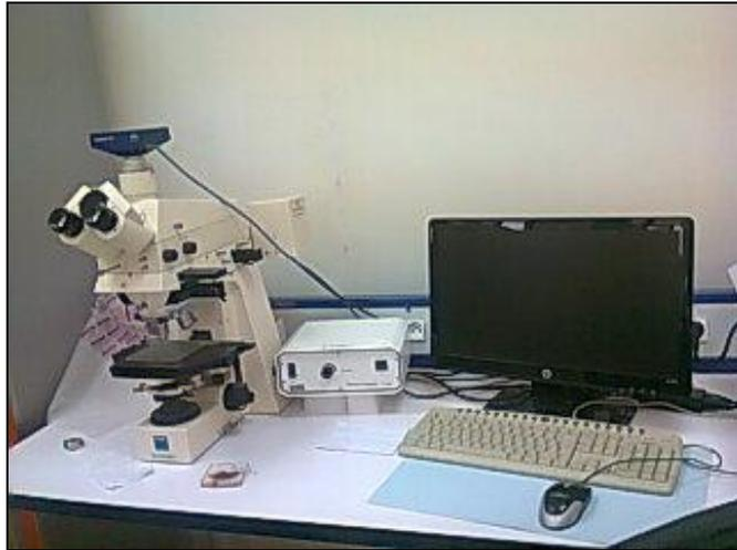
Figure 3 - 15 Microscope optique de type Carl Zeiss
