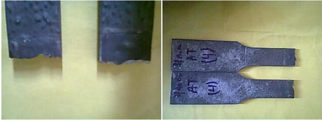
Figure 4 - 29Eprovettes ayant subies l'essai de traction pour une épaisseur de 4 mm
