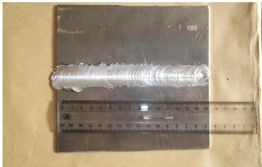
Figure 3 - 9 Spécimen de cordon de soudure FSW de notre matériau
