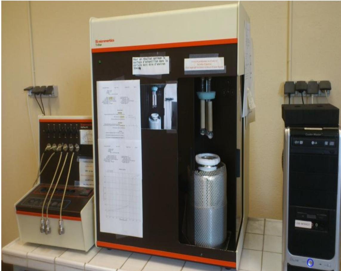
Figure 2.2 : Appareil Micromeritics TriStar 3000 utilisé pour la détermination de la surface BET
