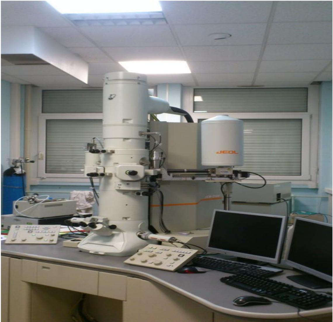
Figure 2.4 : Microscope électronique à transmission JEOL 2100 UHR utilisé pour réaliser les clichés des matériaux étudiés
