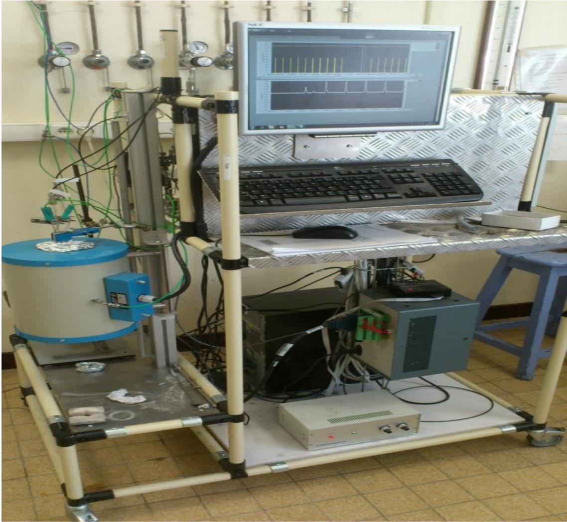
Figure 2.5 : Montage utilisé pour la détermination de l'accessibilité métallique par chimisorption de  $H_2$
