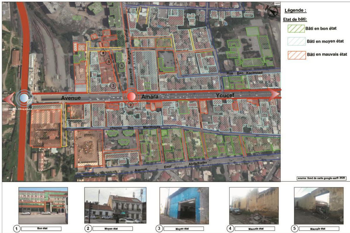
FIG.III.46 : Schéma d'état de bâti de l'aire d'intervention.
