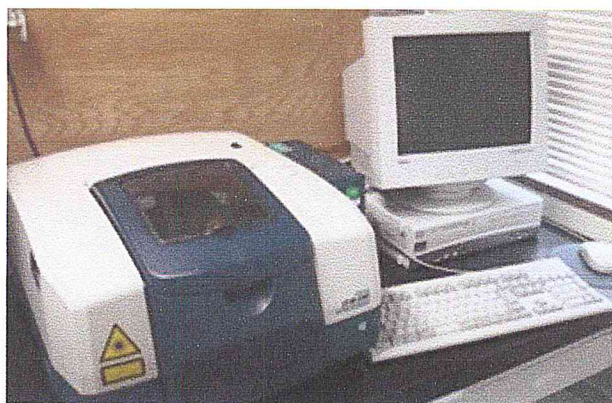
Figure II.4 : Spectromètre infrarouge à transformé de fourrier.
