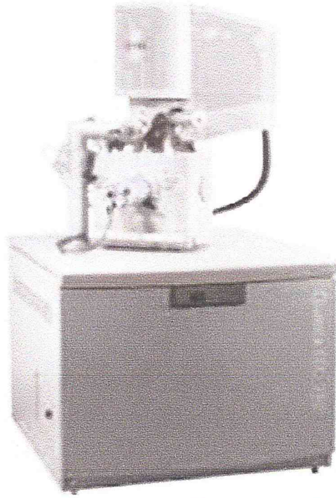
Figure II.9: photo du microscope électronique à balayage utilisé.
