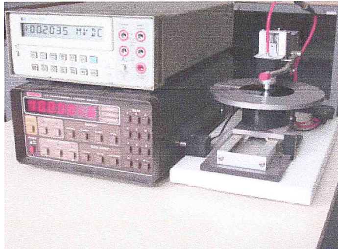
Figure II.8 : équipement utilisé pour la mesure de la résistivité.
