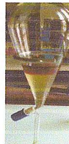
Extraction liquide-liquide avec chloroforme
