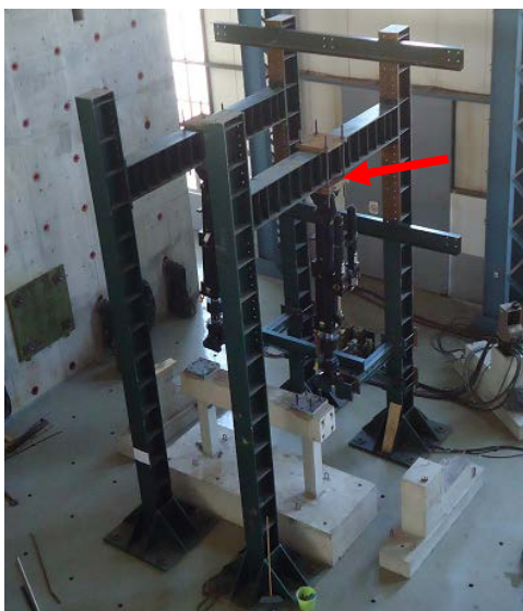
Figure 4.9 : Fixation des vérins verticaux sur le portique de chargement
