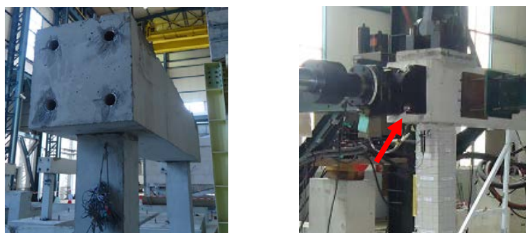
Figure 4.6 : Emplacement des vérins latéraux
