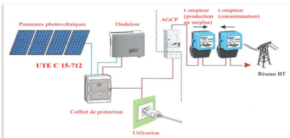
**Figure 2.11. Configuration d'un système PV connecté au réseau avec injection de surplus.**
