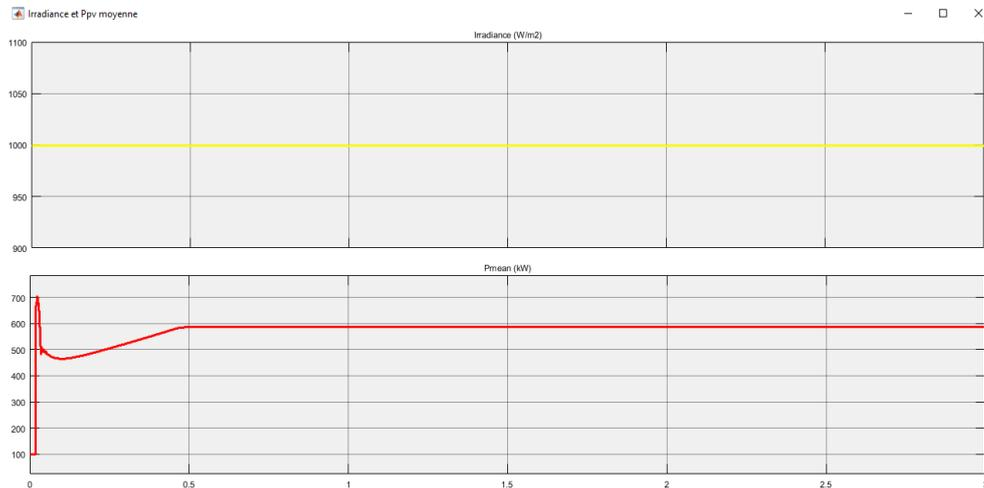
**Figure 3.22. La puissance moyenne à  $25^\circ\text{C}$  et irradiation de  $1000\text{W}/\text{m}_2$**
