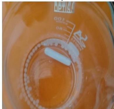
Fig. 17 : Microencapsulation des HE d'orange (original, d'après Lopez et al. (2012) modifié).
