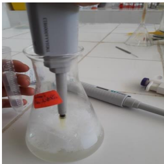
Fig. 18 : Préparation des dilutions D1 et D2 à partir de la solution mère formulée de l'He d'orange (original, 2019).
