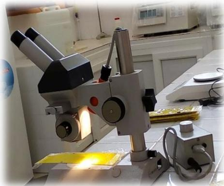
Figure 20 : Loupe binoculaire pour l'identification des espèces capturés
