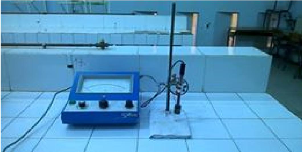
**Figure 13** : un conductimètre
