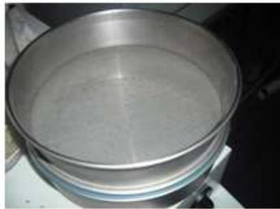
Figure 4.4: Tamis d'ouverture de 1mm
