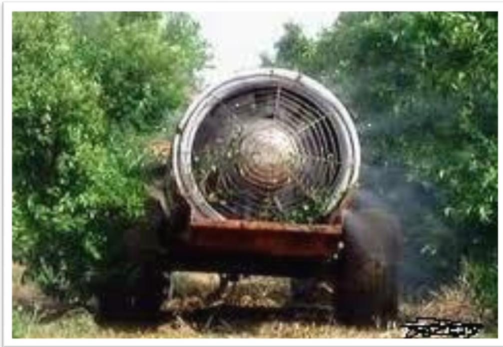
**Figure 5:** Réalisation d'un traitement par un pulvérisateur de type atomiseur.(pesonel)
