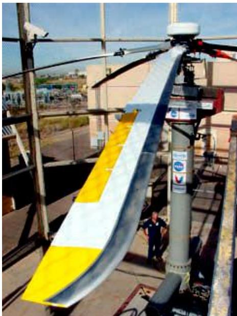
Fig.1.9. Rotor SMART dans une tour d'essai
