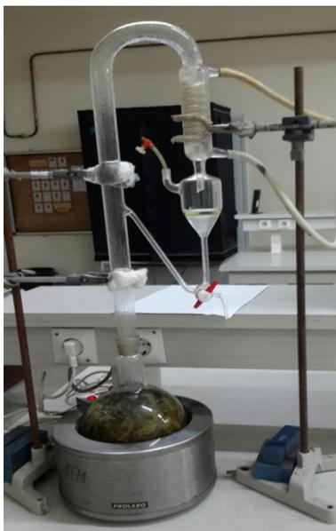
Figure 2.4: Montage de l'appareil Clevenger du procédé de l'hydrodistillation (originale 2015).
