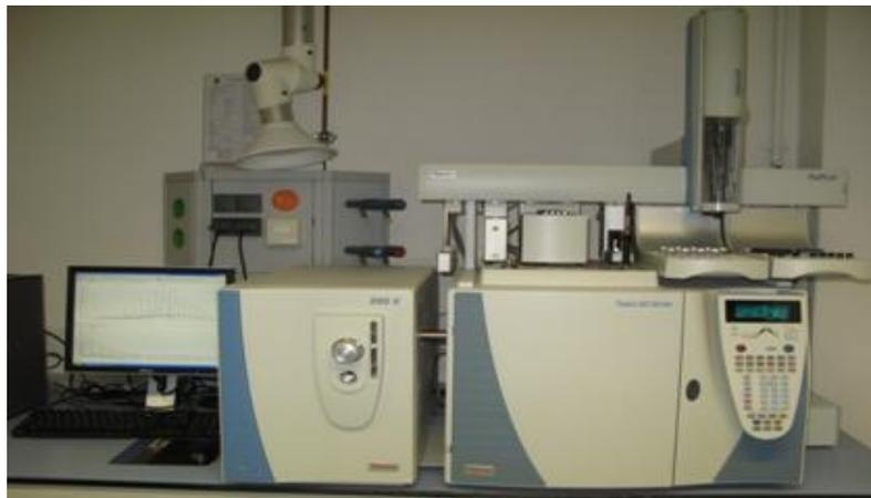
Figure 2.5: Équipement d'analyse CG-SM (originale 2015).
