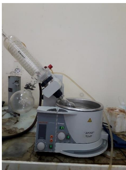
Figure 21 : Concentration de la phase organique par évaporation du solvant à l'aide d'un évaporateur rotatif (Rotavapeur du type BÜCHI).
