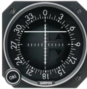
Figure IV.16 : l'aiguille est positionnée au haut du cadran.
