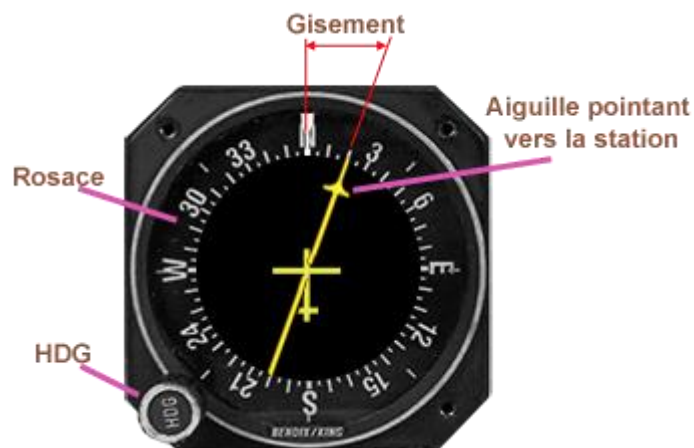
Figure III.14: Indicateur ADF à cadre mobile.
