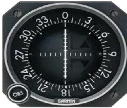
Figure IV.6 : L'aiguille indicatrice est positionnée au centre du cadran
