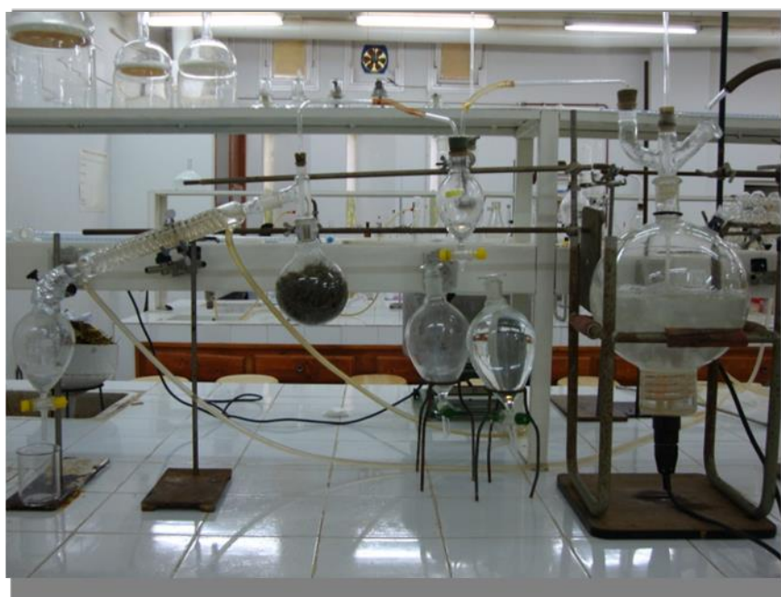
Fig.30 : Montage de l'entraînement à la vapeur d'eau au laboratoire de chimie industrielle» (originale)
