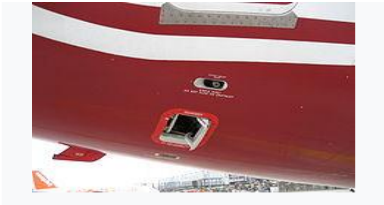
Figure II.2 Soupape permettant l'évaluation de l'air pressurisé non recyclé dans un Boeing 737-800 [18]
