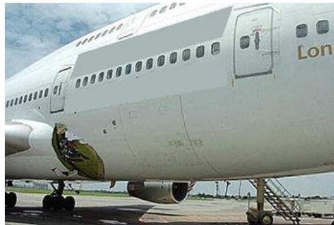
Figure II.10 : Les dégâts dus à l'explosion d'une bouteille d'oxygène en vol sur un Boeing 747-400. [13]
