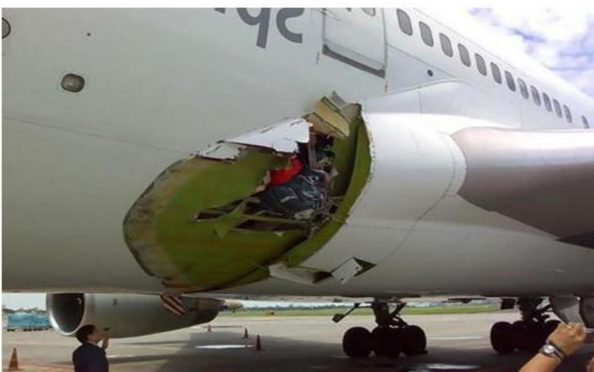
Figure II.4 Décompression à bord d'un avion de Quantas après une explosion en soute [10]
