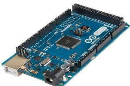
Figure (III-3): Carte Arduino MEGA [28]
