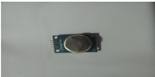
Figure (III-13): Le capteur de gaz
