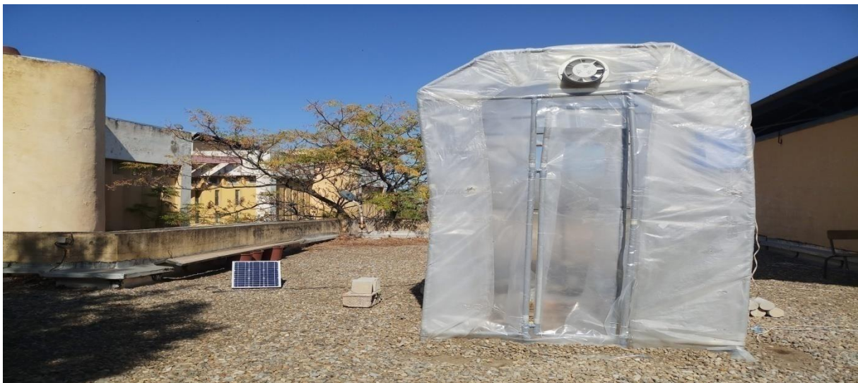
Figure (IV-12): La serre avec l'extracteur et le panneau photovoltaïque
