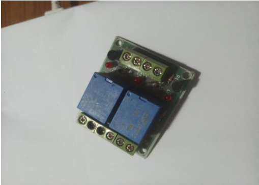
Figure (III-17): Le module double relais
