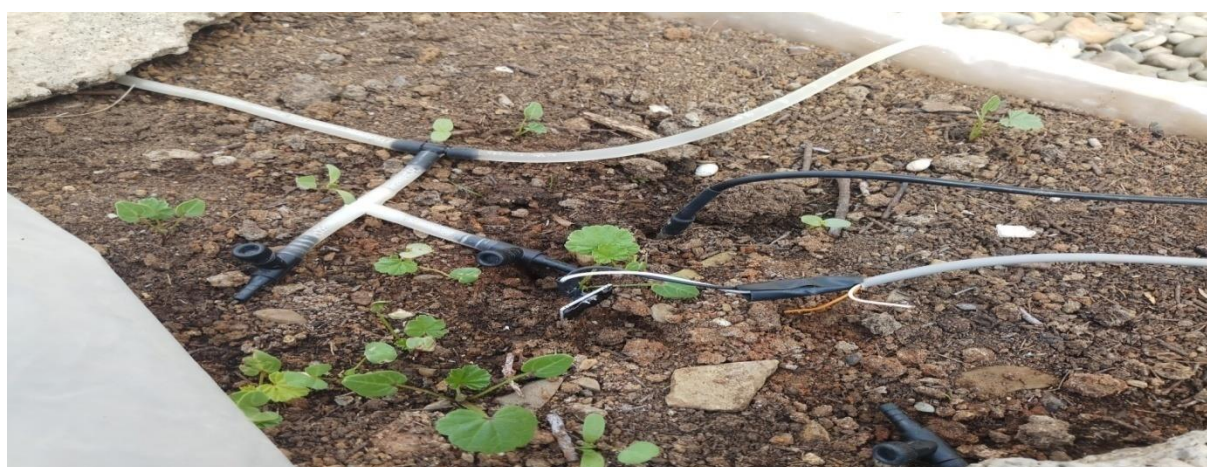
Figure (IV-17): Les capteurs de température et de l'humidité du sol
