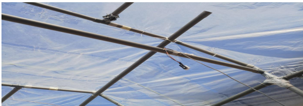
Figure (IV-16): Le capteur DHT22
