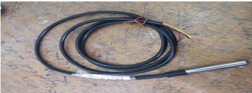
Figure (III-16): Le capteur étanche le DS18B20
