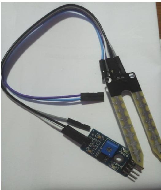
Figure (III-12): Le capteur d'humidité du sol
