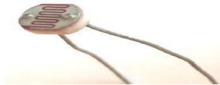
Figure (III-10): Le LDR (capteur de lumière) [28]
