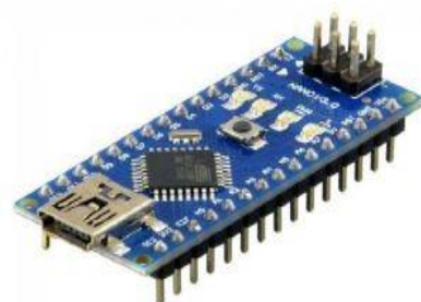
Figure (III-2): Carte Arduino NANO [28]
