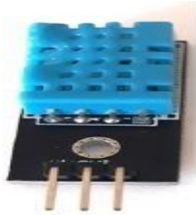
Figure (III-9): Le DHT 11 [28]
