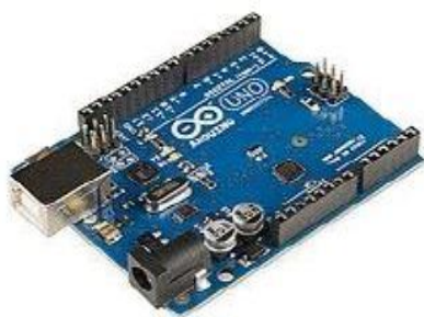
Figure (III-1): Carte Arduino UNO [28]
