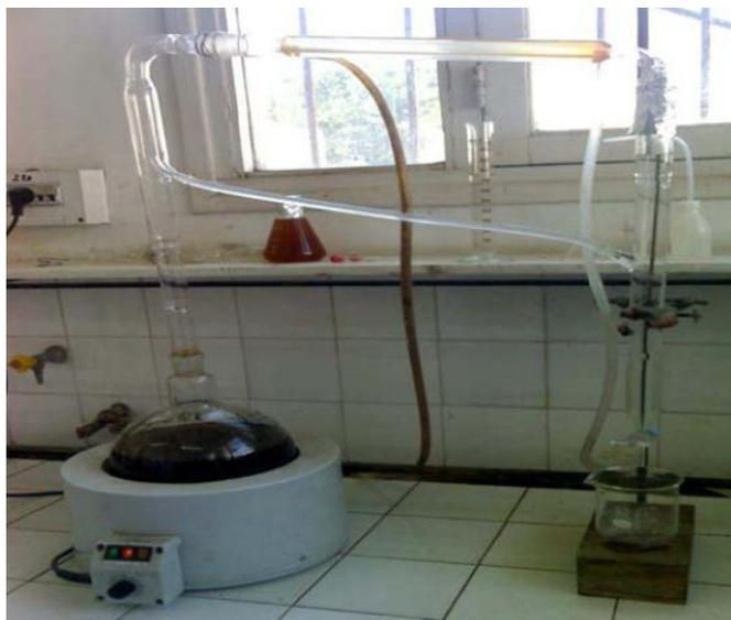
**Fig. 18 :** dispositif d'extraction des huiles essentielles par hydrodistillation
