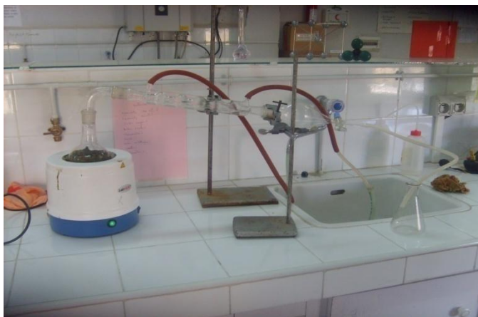
Figure 05: Photo représentant le montage de l'hydro distillation.
