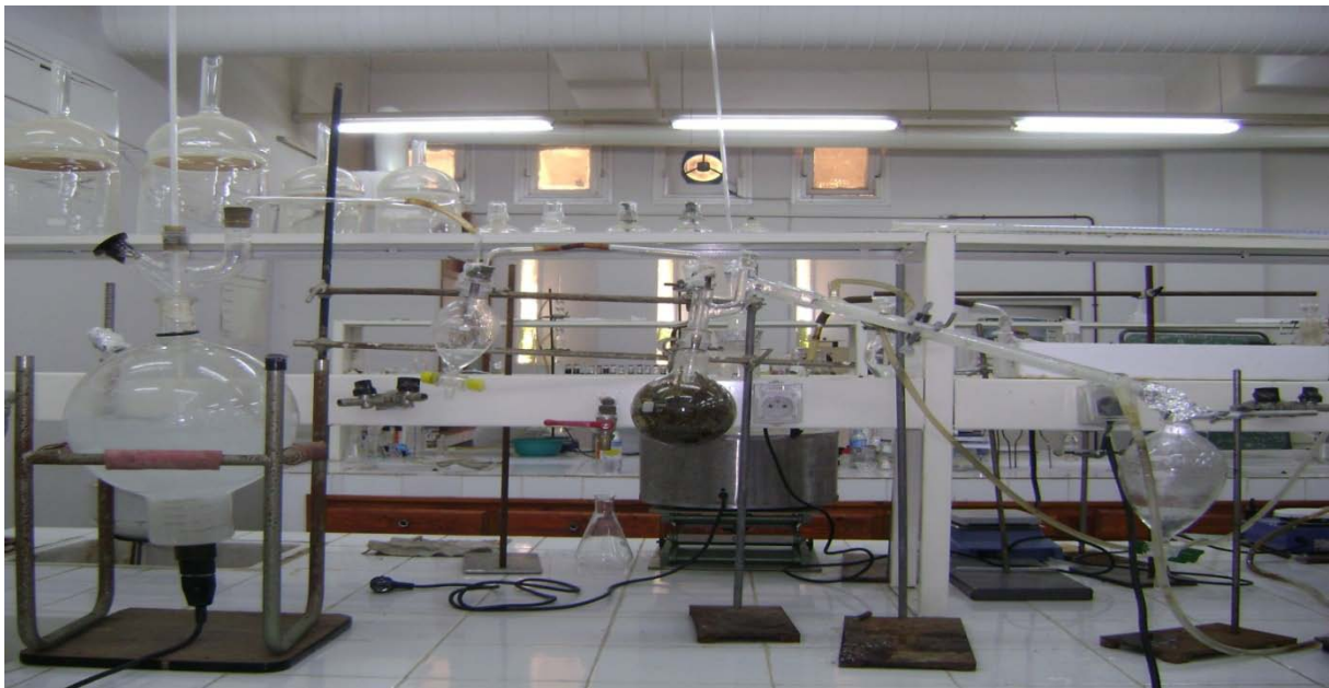
Figure 5 : Extraction par entraînement à la vapeur d'eau de l'huile essentielle des feuilles de l'inule (Original, 2011).
